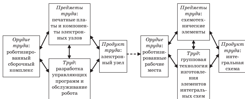
Рис. 5.1. Информационное взаимодействие элементов производственных систем в процессе изготовления электронных узлов и интегральных схем
